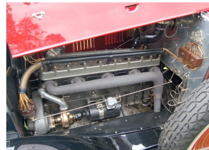
Řadový osmiválec má objem 3.8 litru a výkon 75 k
